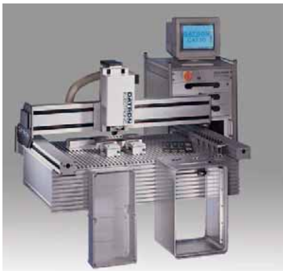
CNC-gesteuertes Bearbeitungszentrum für Gehäuse aus Kunststoff und Aluminium
