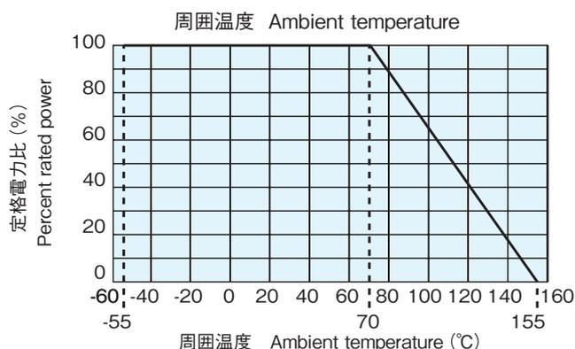
周囲温度70℃以上で使用される場合は、上図負荷軽減曲線に従って、定格電力を軽減して御使用ください。
